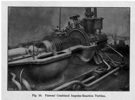
Abb. 10 (a–b): Dampfmaschine nach Watt; Dampfturbine nach Parsons
