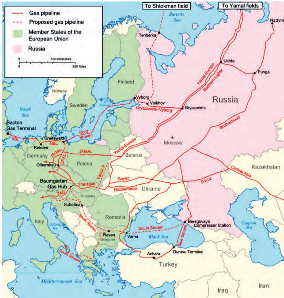
Abb.III.1.12 Verlauf osteuropäischer Gaspipelines
