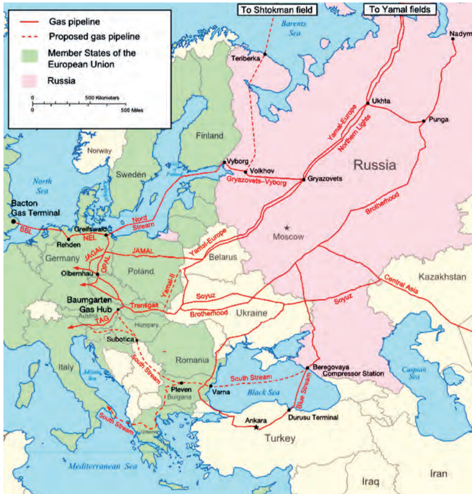
Abb.III.1.12 Verlauf osteuropäischer Gaspipelines
