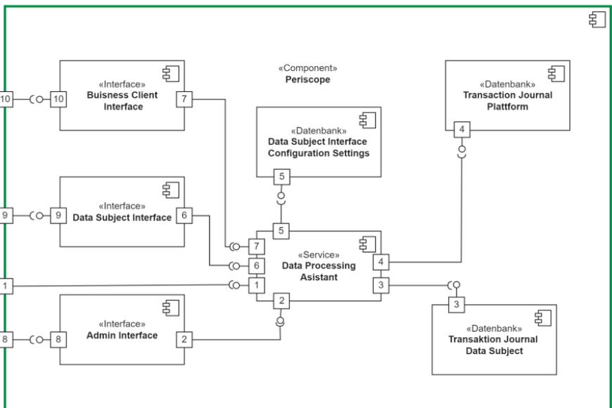
Abb. 2: Die PERISCOPE System-Architektur und -Schnittstellen
