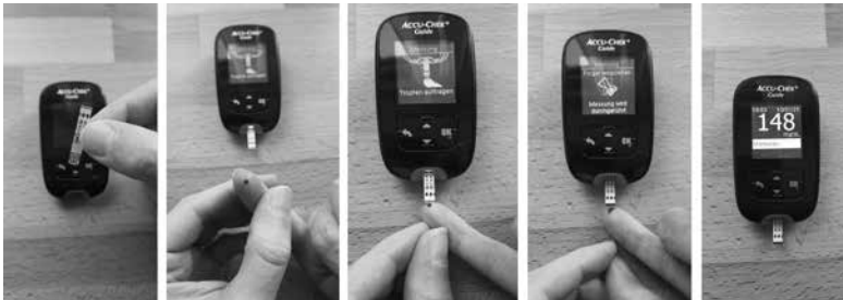
Abb. 10.1-10.5: Der Ablauf des Blutzuckermessens mit dem Accu-Chek Guide, Schmidl/Schmidl, 2021.
