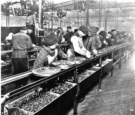
Abbildung 9: „Flywheel Magneto“-Montagelinie, Highland Park (1913)
