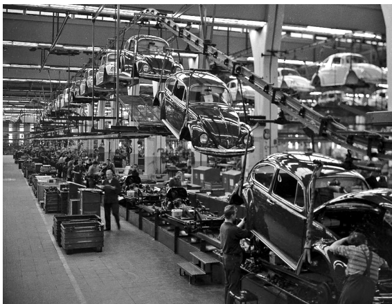
Abbildung 45: Montagearbeit im Vorderwagen im Werk Wolfsburg (1962)
