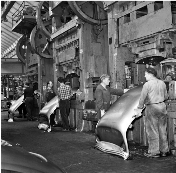
Abbildung 40: Teileentnahme aus einer Großpresse im Werk Wolfsburg (1957)
