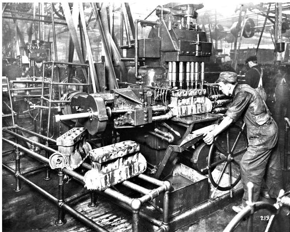
Abbildung 8: Mechanische Bearbeitung von Zylinderblöcken im Werk Highland Park (1914)
