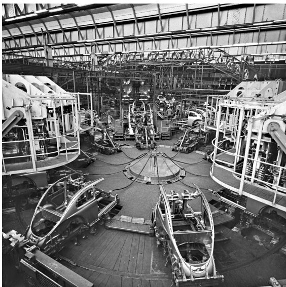
Abbildung 43: Hinterwagen-Karussell im Karosseriebau Werk Wolfsburg (1962)
