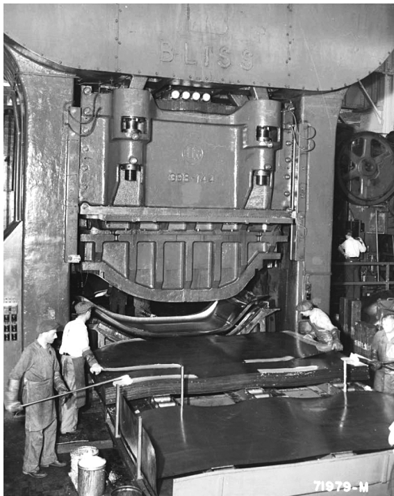
Abbildung 27: Pressen des Dachteils (1939)
