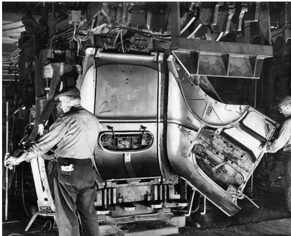
Abbildung 29: Vorbereitung zur Verschweißung der Hinterwagen-Karosserie in einer der Monster-Schweißmaschinen
