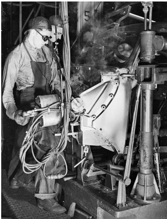
Abbildung 30: Nahtschweißer im Karosseriebau des Werks River Rouge (1936)
