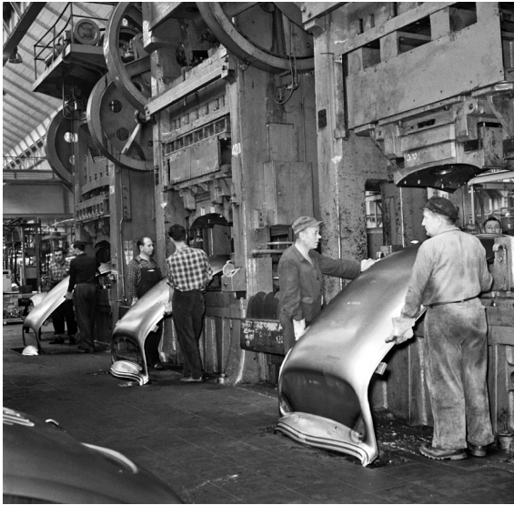
Abbildung 40: Teileentnahme aus einer Großpresse im Werk Wolfsburg (1957)
