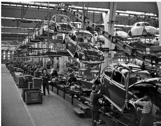
Abbildung 45: Montagearbeit im Vorderwagen im Werk Wolfsburg (1962)
