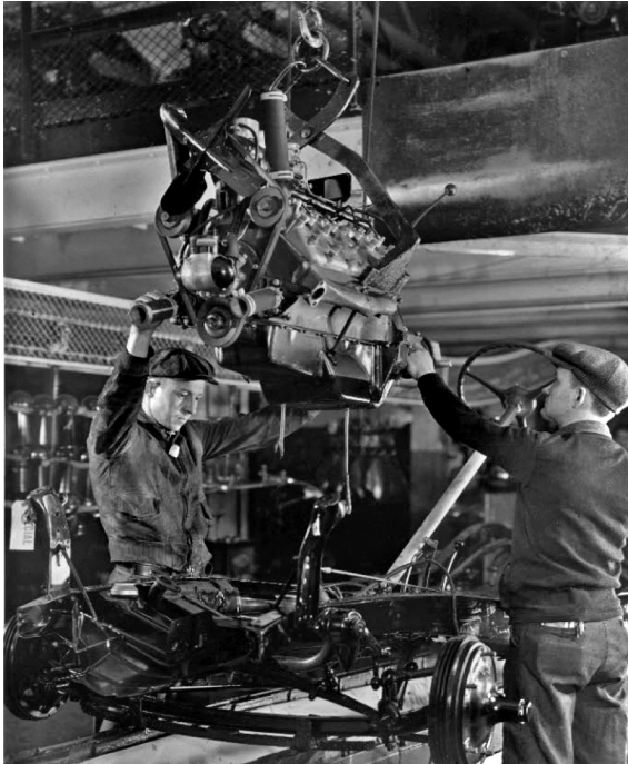
Abbildung 31: Einbau des Motors in das Chassis im Werk River Rouge (1936)
