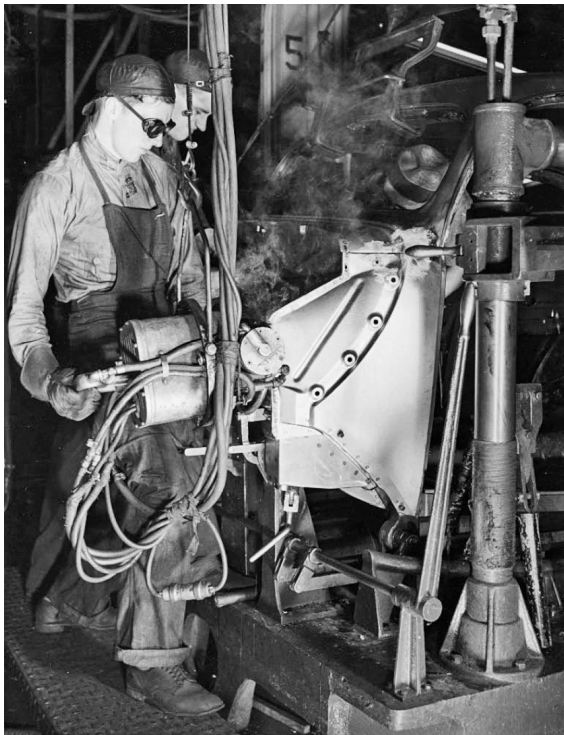
Abbildung 30: Nahtschweißer im Karosseriebau des Werks River Rouge (1936)
