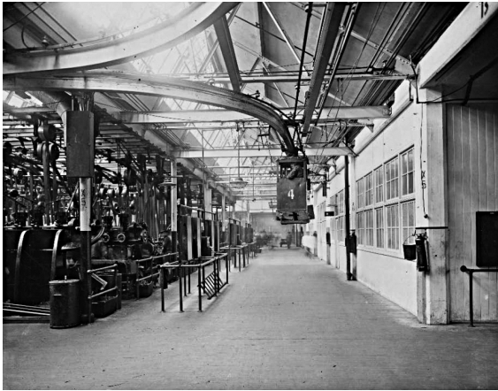
Abbildung 7: Hängebahn für den Teiletransport im Werk Highland Park (1914)
