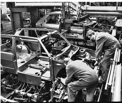
Abbildung 51: Arbeiten im Motorraum des Golf 1 (links) und des Golf 2 (rechts)
