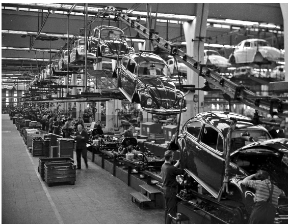
Abbildung 45: Montagearbeit im Vorderwagen im Werk Wolfsburg (1962)
