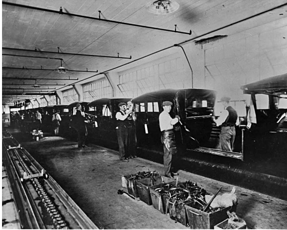
Abbildung 16: Fahrzeugendmontage im Werk Highland Park (ca. 1914)
