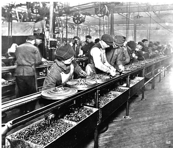
Abbildung 9: „Flywheel Magneto“-Montagelinie, Highland Park (1913)
