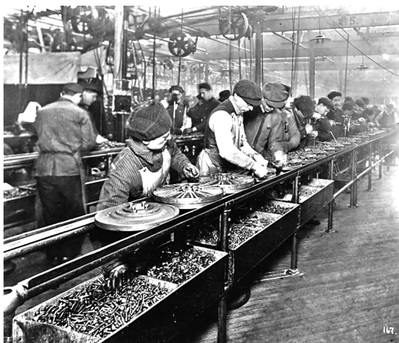
Abbildung 9: „Flywheel Magneto“-Montagelinie, Highland Park (1913)
