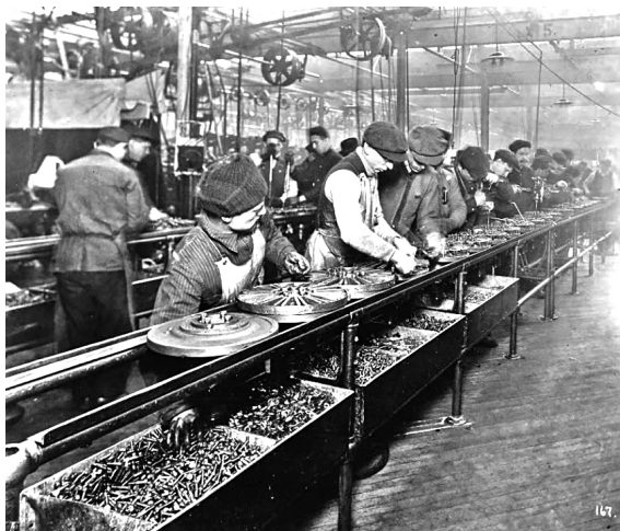
Abbildung 9: „Flywheel Magneto“-Montagelinie, Highland Park (1913)
