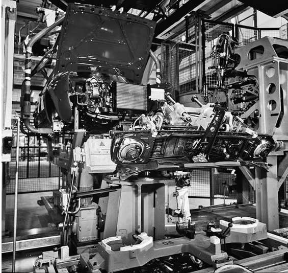
Abbildung 53: Automatisierter Einbau des Frontend in Halle 54
