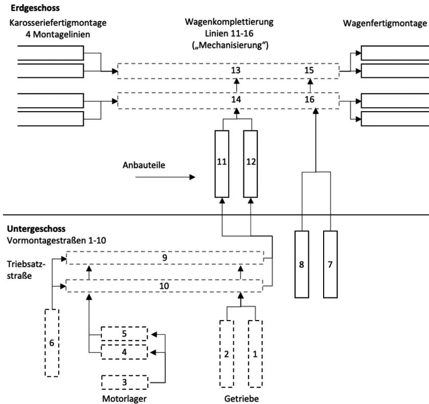
\* 1 u. 2: Triebwerke; 3: Motorlager; 4 u. 5: Triebwerke; 6: Hilfsrahmen; 7 u. 8: Frontend; 9 u. 10: Triebwerkstraßen; 11 u. 12: Anbauteile; 13-16: Wagenkomplettierung
