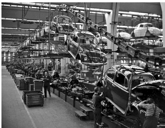
Abbildung 45: Montagearbeit im Vorderwagen im Werk Wolfsburg (1962)
