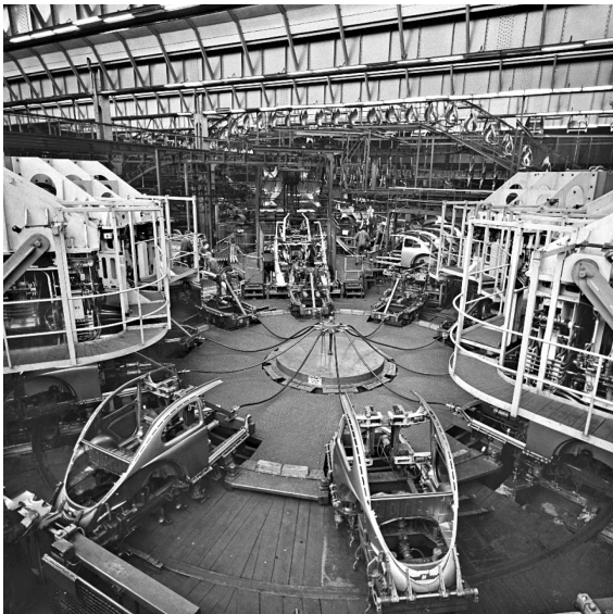
Abbildung 43: Hinterwagen-Karussell im Karosseriebau Werk Wolfsburg (1962)
