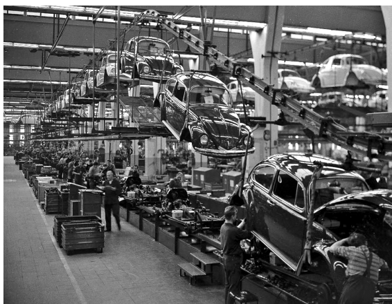
Abbildung 45: Montagearbeit im Vorderwagen im Werk Wolfsburg (1962)
