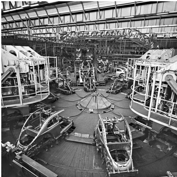
Abbildung 43: Hinterwagen-Karussell im Karosseriebau Werk Wolfsburg (1962)
