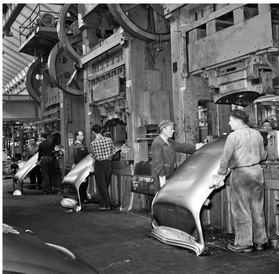
Abbildung 40: Teileentnahme aus einer Großpresse im Werk Wolfsburg (1957)
