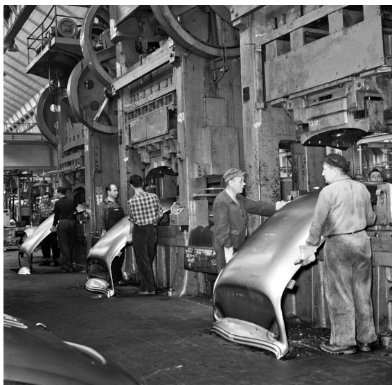
Abbildung 40: Teileentnahme aus einer Großpresse im Werk Wolfsburg (1957)
