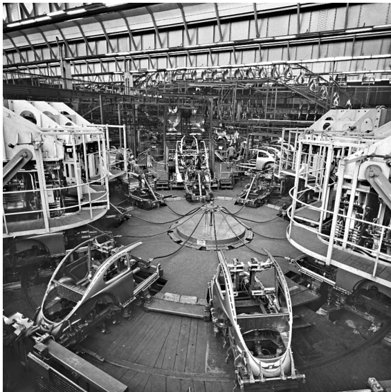
Abbildung 43: Hinterwagen-Karussell im Karosseriebau Werk Wolfsburg (1962)
