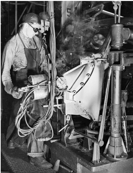
Abbildung 30: Nahtschweißer im Karosseriebau des Werks River Rouge (1936)
