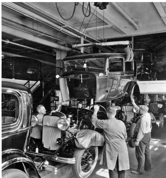
Abbildung 33: Der Body Drop beim Modell A im Werk River Rouge (1932)
