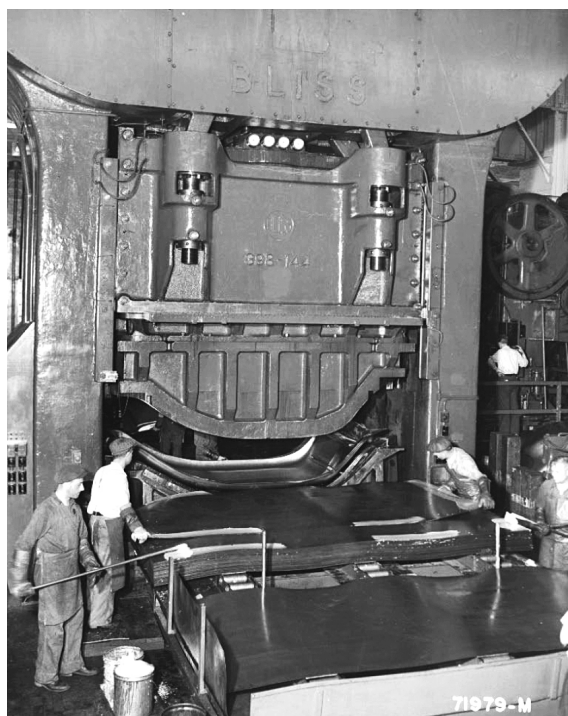
Abbildung 27: Pressen des Dachteils (1939)
