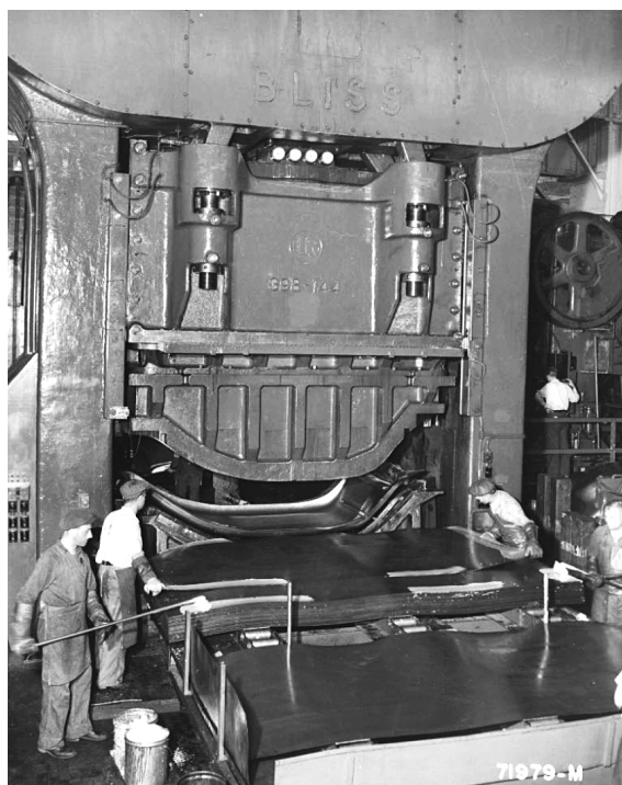
Abbildung 27: Pressen des Dachteils (1939)
