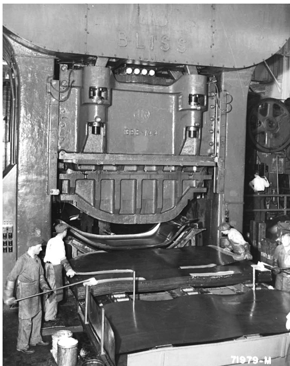
Abbildung 27: Pressen des Dachteils (1939)
