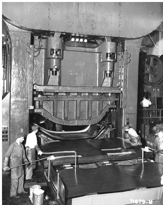
Abbildung 27: Pressen des Dachteils (1939)
