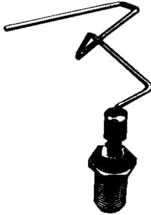
Abbildung 5: Eine evolutionär designte Antenne für einen Satelliten
