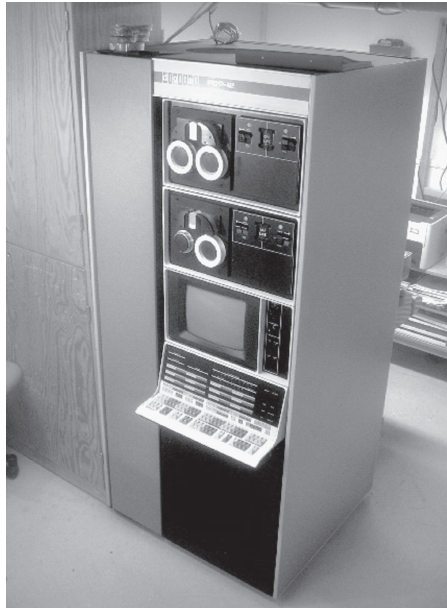
Abbildung 1: DEC-Minicomputer PDP-12, in den 1970er Jahren eingesetzt an diversen Universitäten
