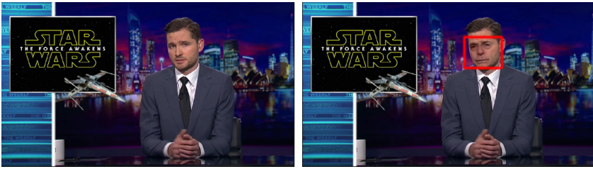
Abbildung 4.4: links: originaler Video-Frame; rechts: Deepfake-Manipulation und Gesichtserkennung (rot)
