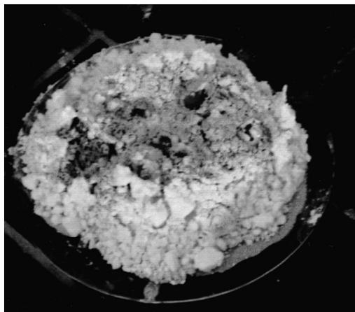
Abb. 2: Schwefel, der auf den Kalk geschüttet war und erst wegen der Volumenvergrößerung des reagierenden Kalkes seitlich abgerutscht ist, hat sich entzündet. Die Temperatur im aktiven Kern ist deutlich über  $300^{\circ}\text{C}$ . Der Durchmesser der Glasschale ist 20 cm, ca. 150 g Kalk und ca. 100 g Schwefel wurden verwendet (farbige Abbildung im Internet: [http://www.edition-sigma.de/TG/H1\\_07/AbbNibler.PDF](http://www.edition-sigma.de/TG/H1_07/AbbNibler.PDF)).
